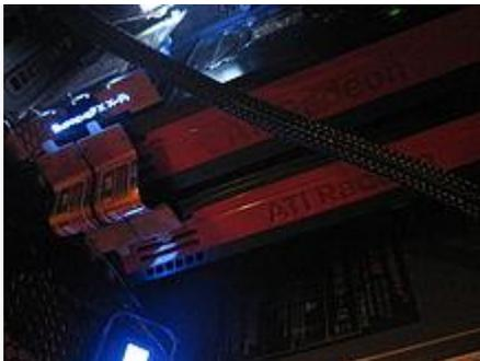
2 видеокарты ATI (AMD) Radeon HD 5870, соединенные по технологии AMD CrossFireX
