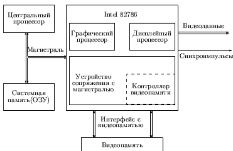
Рис. 0.2.10: Использование сопроцессора Intel 82786 в графической дисплейной системе
