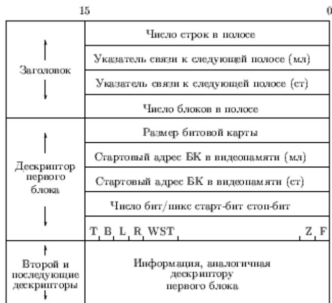
Рис. 0.2.12: Структура управляющего блока дескриптора оконного сегмента для i82786. T,B,L,R - управляющие биты для верхней, нижней, левой и правой границ; WST - статус окна; Z - увеличение; F - фоновое поле.
