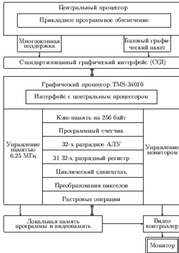
Рис. 0.2.8: Использование TMS-34010 в графической системе
