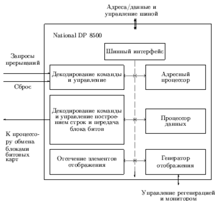
Рис. 0.2.13: Структурная схема растрового графического процессора DP-8500 фирмы National Semiconductor
